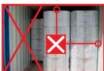
3. Le transport en cale doit s'effectuer en combinaison avec une bâche isolante en mousse de polystyrène expansé ou un recouvrement de plusieurs couches de carton (solution la moins efficace).
